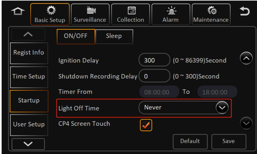
Light Off Time: 30 s, 1 min, 3 min, 5 min, 10 min, and never.
