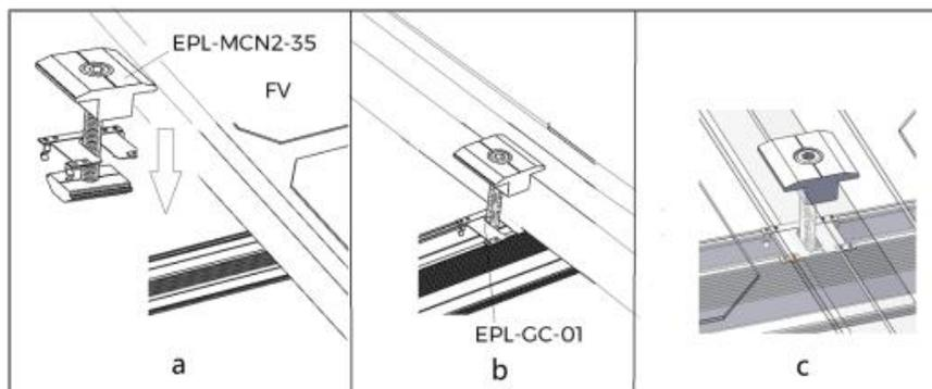
D) Instalación del conector para puesta a tierra.
