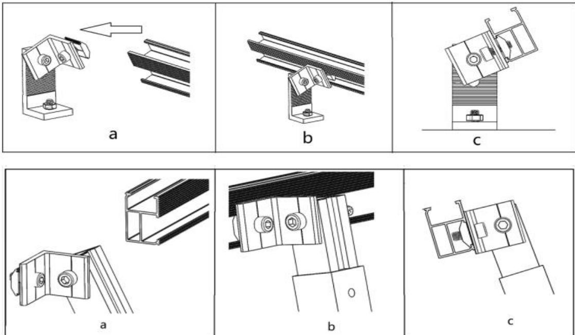
\*Dependiendo de la cantidad de módulos solares a instalar, el riel podría requerir un conector para extender la longitud del riel, si es necesario revise el siguiente paso.
