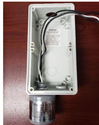
5. Conecte los cables negros (CA) o negro y rojo (CD) del supresor en la parte superior de la pastilla térmica, y el cable blanco o verde, según corresponda, llévelo a neutro-tierra física.
