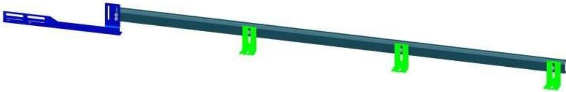
3 .-Coloque los juegos de guías en ambos lados de las perforaciones del garaje verticalmente colocarlos a nivel, la distancia adecuada del borde al agujero es de 150 mm, la distancia inferior es de 100mm, la distancia superior es de 180mm, A=B. A continuación, sujetar los tornillos de las pistas.
