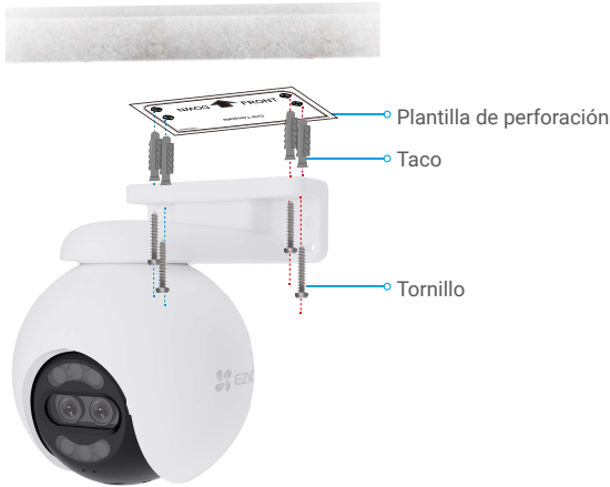
Figura 1. Montaje en techo
