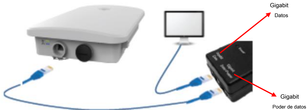
Figura 2 Instalación del adaptador cnPilot a PoE
