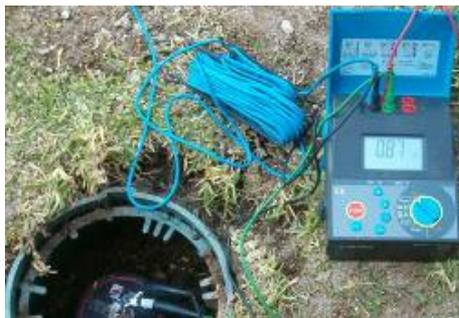
La distancia de separación entre el electrodo y la punta de corriente del megger (trayectoria A-C) debe ser de 10m. La medición de la resistencia del terreno se realizará a una distancia de 5m del electrodo en el punto B sobre la trayectoria A-C. Evite, en lo posible, que en la trayectoria de los puntos de prueba y el electrodo existan tuberías de metal. cuidando que los puntos de medición cumplan con los requisitos antes mencionados.
