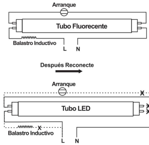
Desconecte la energía, remueva el tubo fluorescente y arranque y el balastro inductivo, corte los cables conectados al balastro.
