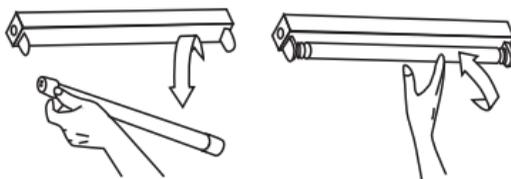
Desconecte la energía, remueva el tubo anterior de la base y ponga el tubo nuevo. Este tubo led se alimenta solo de un lado.
