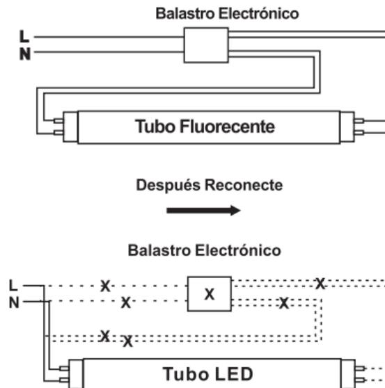
Desconecte la energía, remueva el tubo fluorescente y el balastro electrónico, corte los cables conectados al balastro.
