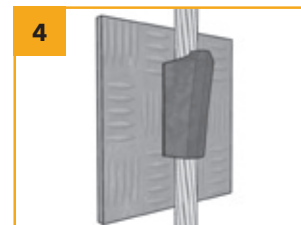
UNIÓN CABLE PASANTE A ESTRUCTURA METÁLICA VERTICAL
