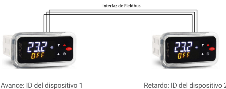
Figura 4 Conectividad de red de avance-retardo
