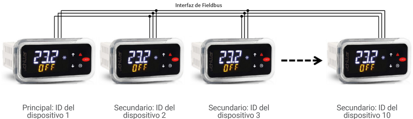
Figura 3 Conectividad de red de principal-secundario
