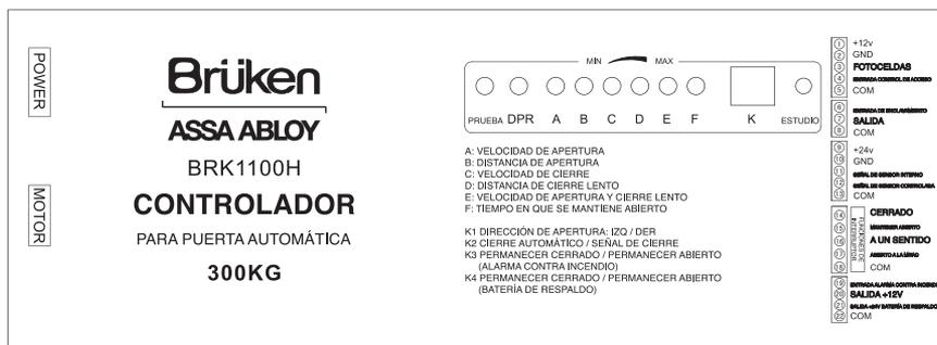
PRUEBA: Una pulsión inicia una trayectoria completa de apertura y cierre y se puede usar para ajustar todos los parámetros durante la instalación.
