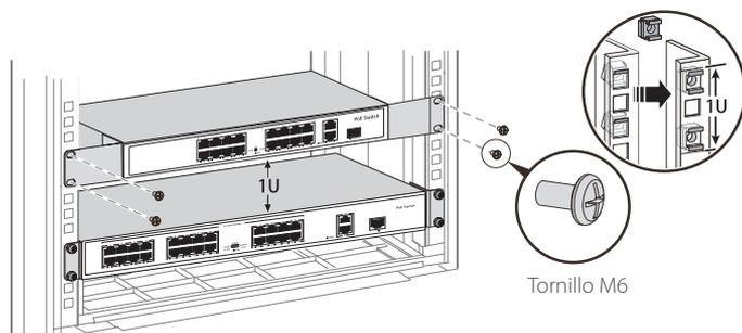
1. Instale los 4 tornillos de fijación en la barra de agujeros frontal del rack, 2 de cada lado.
