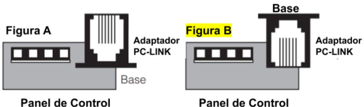
Conecte el cable de conexión al adaptador PC-Link y al conector DB-9. Conecte el conector DB-9 a un puerto serie de la computadora que se utilizará para la descarga.
