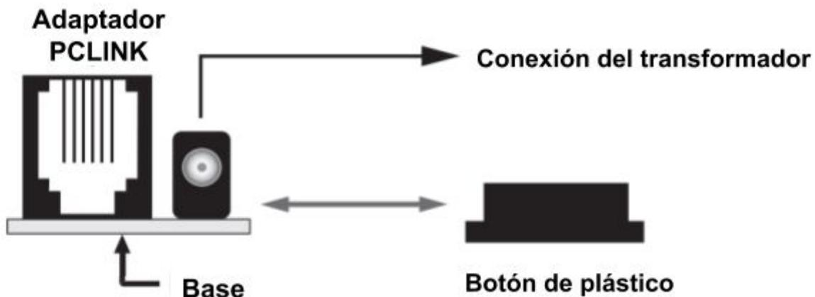
**NOTA:** PC-Link 5SP solo es compatible con productos que tienen un cabezal PC-Link de 5 pines.
