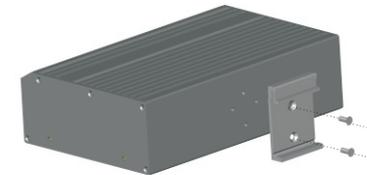
Figura 2-1 Diagrama de instalación de soportes de riel DIN
