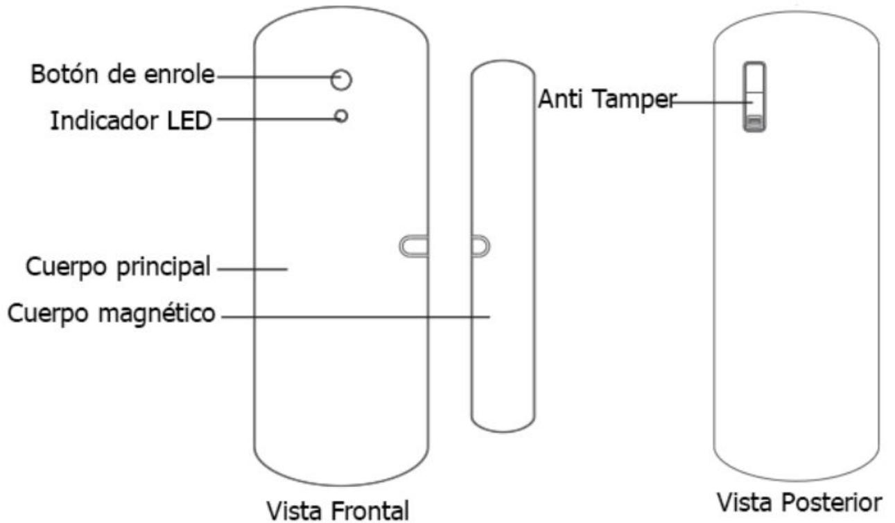
De acuerdo al principio magnético, una vez que el cuerpo magnético y el cuerpo principal se separan 25mm, el transmisor va enviar el mensaje de alarma para evitar una intrusión.
