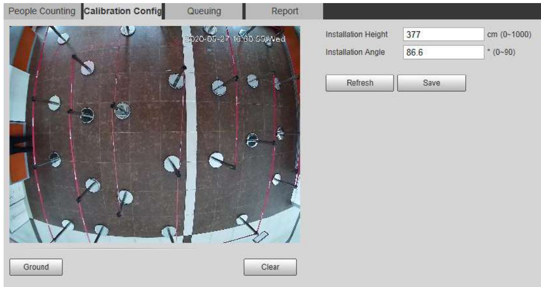
Figura 5-61 Configuración de calibración (análisis estéreo)
