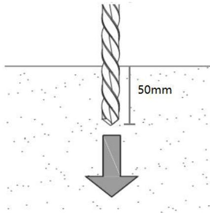
2. Use tornillo de expansión para fijar la pata delantera y el grupo de patas ajustables, El tamaño de la base de cemento sugieren 450\*450\*450mm C30
