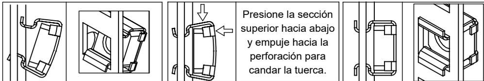
Presione la sección superior hacia abajo y empuje hacia la perforación para candar la tuerca.
