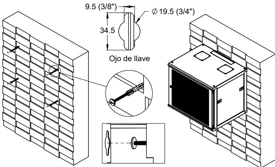
Presentar el gabinete en la pared, para marcar las posiciones de las perforaciones; posteriormente, instalar la tornillería de montaje.
