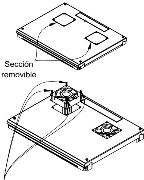
Después de desprender las cubiertas, atornillar los ventiladores (venta por separado) con los tornillos que deberán incluir los ventiladores.
