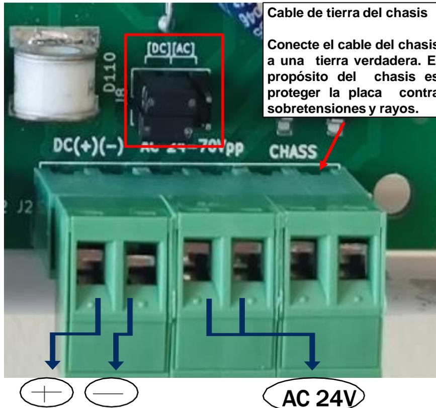
Si se va alimentar la tarjeta a **12-48 VDC** hay que hacer los 2 puentes con los **Jumper en DC**. Respectivamente conectar en los bornes de DC (+)(-).
