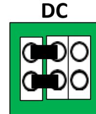
Si se va alimentar la tarjeta a **24VAC** hay que hacer los 2 puentes con los **Jumper en AC**. Respectivamente conectar en los bornes de AC 24-70Vpp
