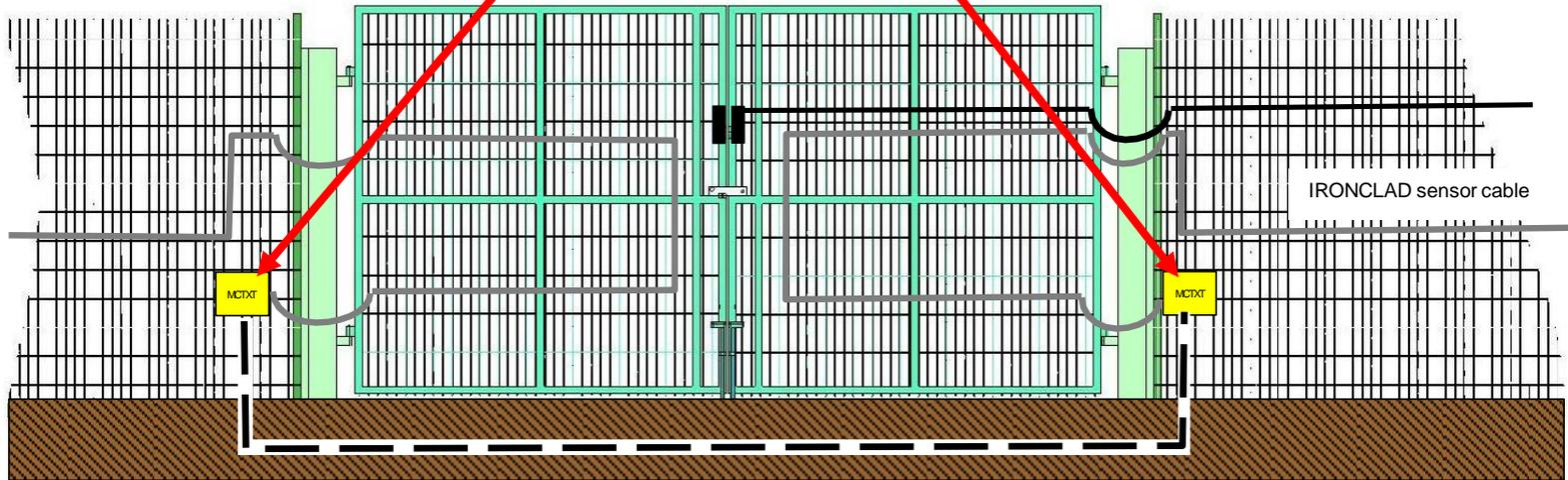
Cable no sensible RG6 Enterramiento directo debajo de la puerta en conducto impermeable
