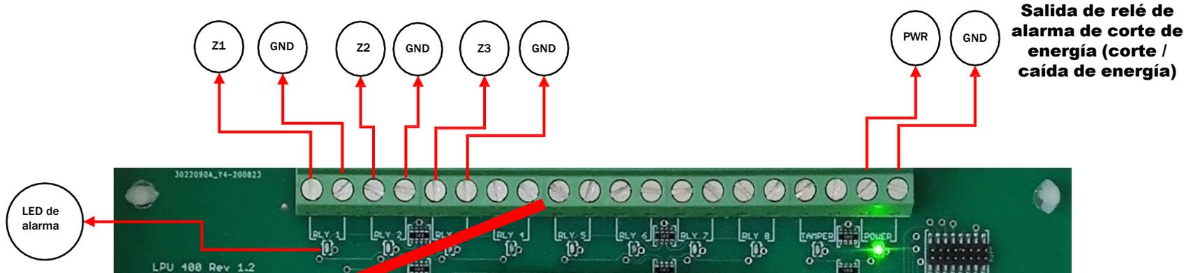
Salida de relé de alarma de corte de energía (corte / caída de energía)
