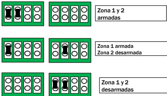
Estos jumper nos sirven para activar y desactivar la zonas que estaremos usando o no.
