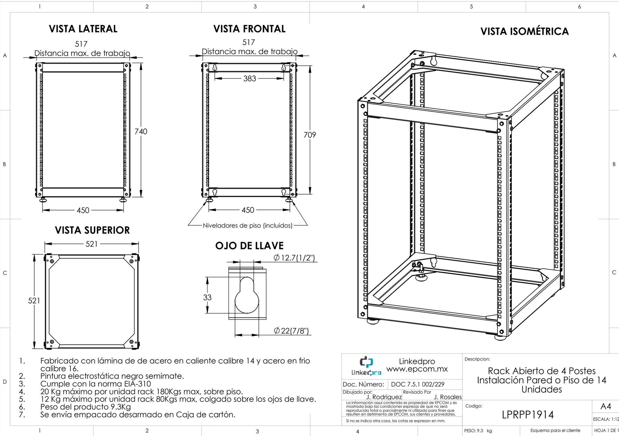
1. Fabricado con lámina de de acero en caliente calibre 14 y acero en frio calibre 16.
