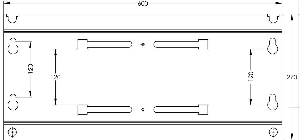
1. Fabricado en lámina de acero calibre 11 y 14, recubierta con galvanizado electrolítico.
