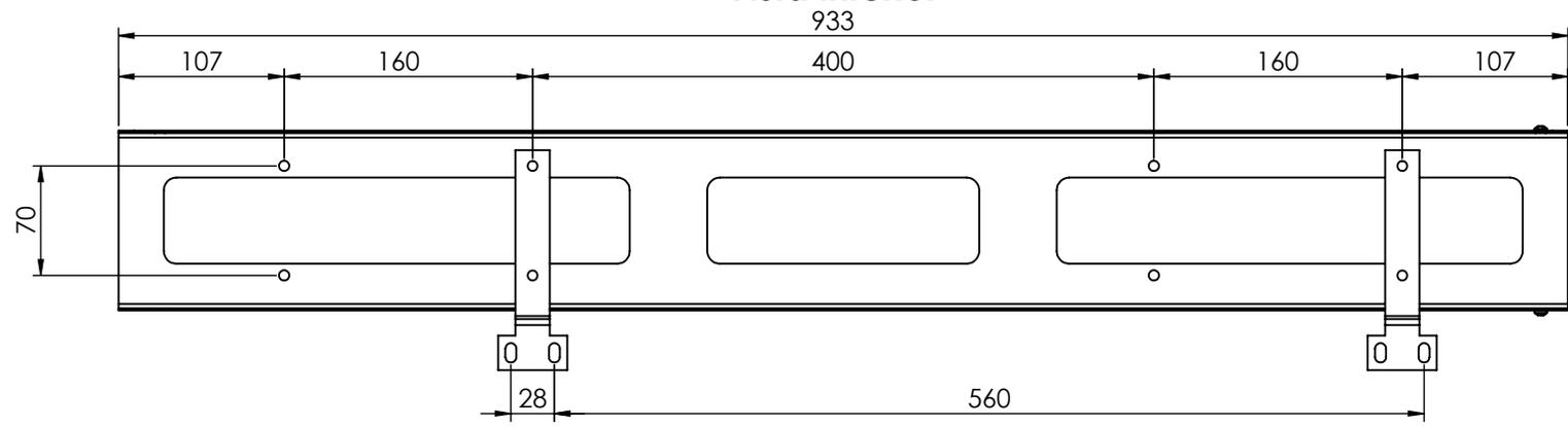
1. Fabricado en lámina de acero calibre 18 y 22.
