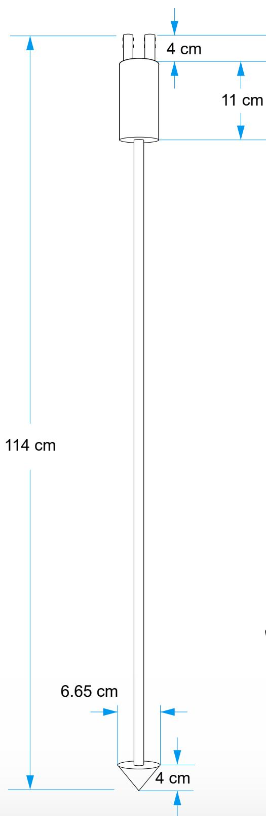
Fabricado en cobre electrolítico, termina en punta cónica para garantizar el menor nivel de resistencia y una mayor área de contacto con el terreno. Equipado con un filtro equipotencial autoconectable y empalme de acero inoxidable.
