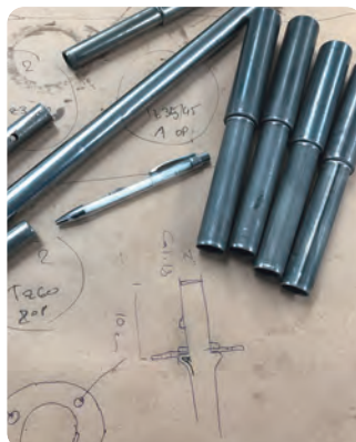
Reducción de niple por compresión
