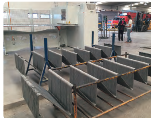
Doblado de "Z" por control numérico
