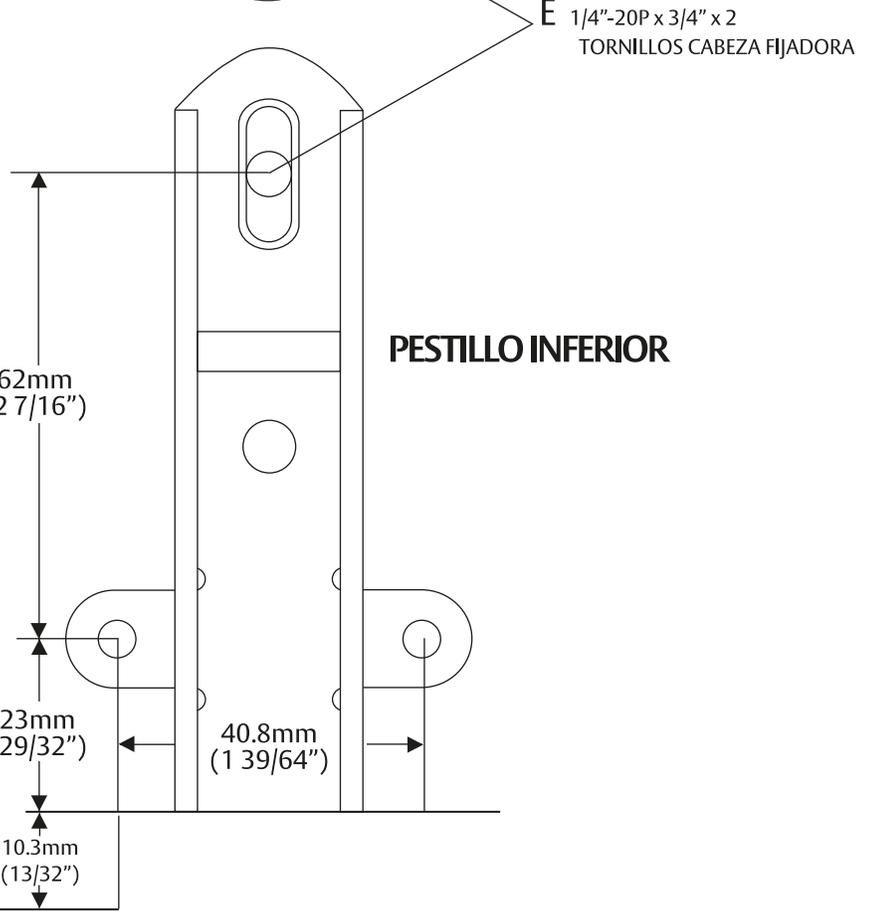
**PRECAUCIÓN:** Asegúrese que la distancia de la parte inferior de la puerta y la parte inferior del pestillo sea de 10.30mm (13/32").
