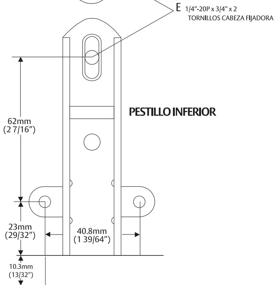
**PRECAUCIÓN:** Asegúrese que la distancia de la parte inferior de la puerta y la parte inferior del pestillo sea de 10.30mm (13/32").
