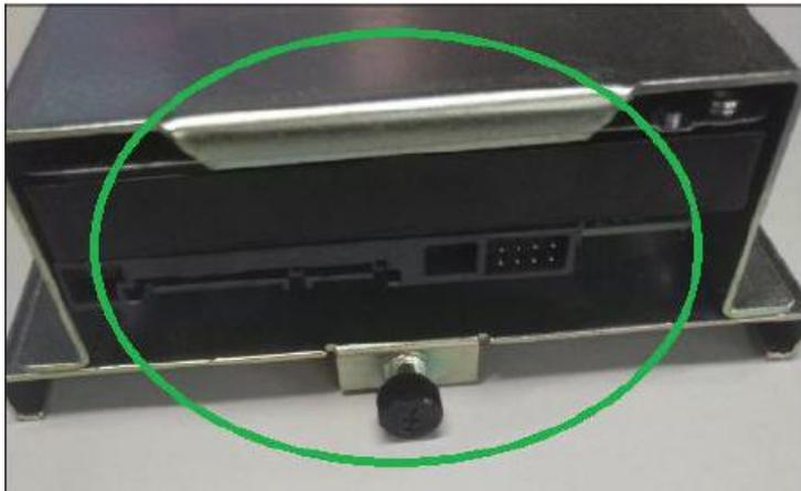
1.4- Coloque los tornillos para sujetar el disco al montaje.
