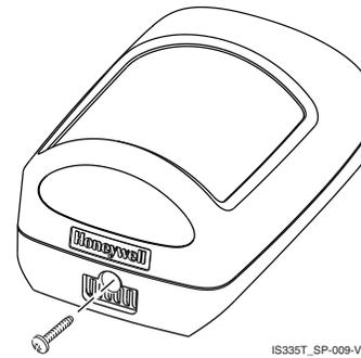
1. Cerrar el sensor y aplicar energía al sensor. La inicialización finaliza cuando el LED deja de parpadear lentamente (< 45 segundos).
