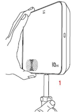
1. Con un destornillador Phillips pequeño, apriete el tornillo de bloqueo de la parte inferior del panel para asegurarlo a la pared.
