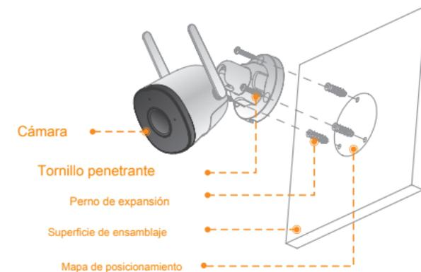
**Paso 1** Taladre orificios para tornillos en la superficie de montaje como muestra el mapa y luego coloque los pernos de expansión.
