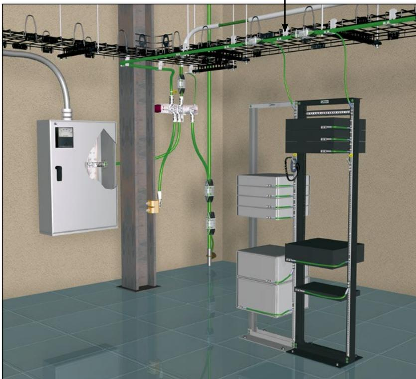
Nota: El sistema Wyr-Grid® de Panduit no requiere una conexión de unión entre las secciones porque se unen automáticamente a través de los accesorios de unión y derivación Wyr-Grid®. Sin embargo, el sistema debe unirse a la infraestructura de puesta a tierra.
