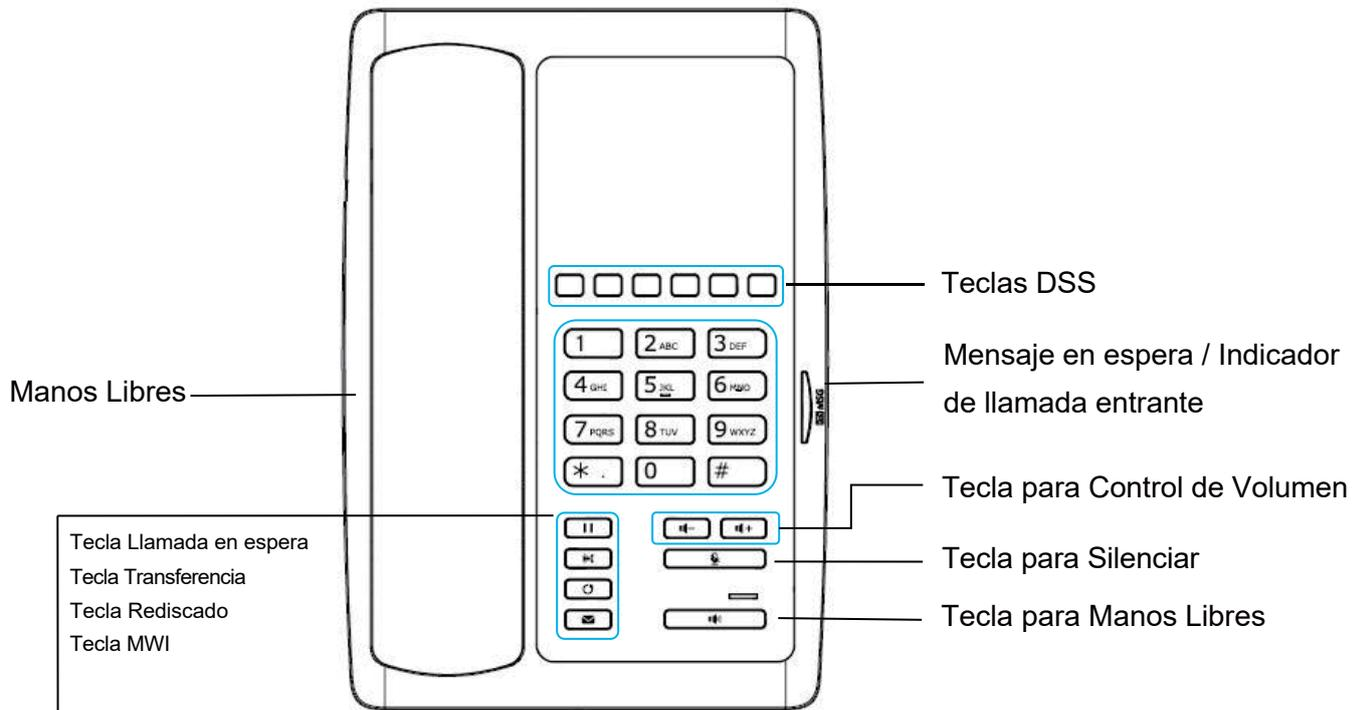
La imagen de arriba muestra el diseño del teclado del dispositivo. Cada tecla proporciona una función específica. El usuario debe consultar la ilustración en esta sección sobre el uso de cada tecla y la descripción sobre cada función se muestra a continuación:
