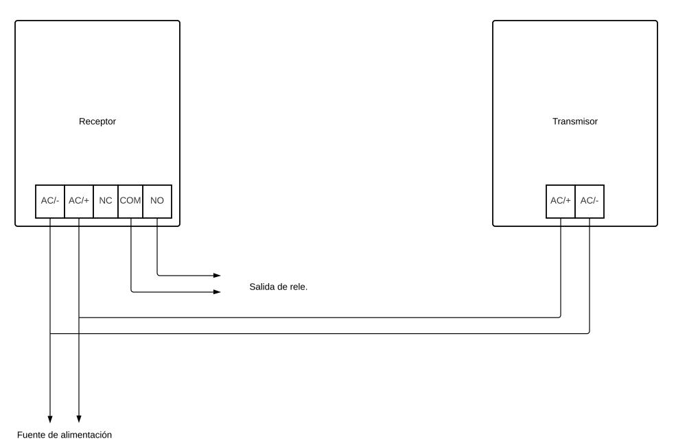
La mejor altura de instalación debe ser de 20 cm, la distancia de instalación no debe superar los 2 metros. La instalacion del equipo debe estar perpendicular al equipo a protejer.
