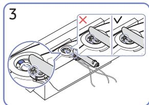
3 Coloque el pie de soporte en el monitor, tal como se muestra en la figura.
