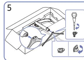
5 Inserte la base del soporte en el pie de soporte, en la dirección que se muestra en la figura.
