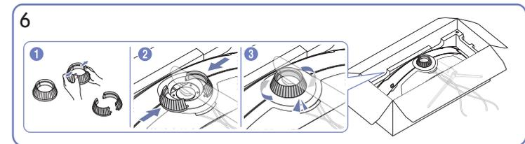
6 Desensamble la CUBIERTA TRASERA SUPERIOR. Ensamble la CUBIERTA TRASERA SUPERIOR con el pie de soporte, tal como se muestra en la figura. Gire la CUBIERTA TRASERA SUPERIOR en el sentido de las agujas del reloj.
