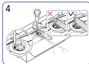
4 Ajuste los tornillos en la parte superior del pie de soporte.
