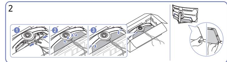
2 Junte los cables y alíneelos con la ranura central de la CUBIERTA TRASERA INFERIOR. Ensamble la CUBIERTA TRASERA INFERIOR en la parte posterior del producto.
