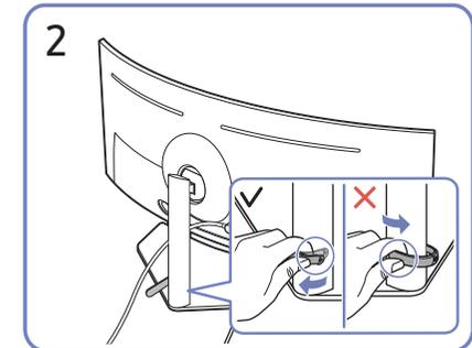
Hale el lado derecho del SOPORTE DE CABLES para separarlo del soporte. El lado izquierdo del SOPORTE DE CABLES se puede dañar si emplea demasiada fuerza.
