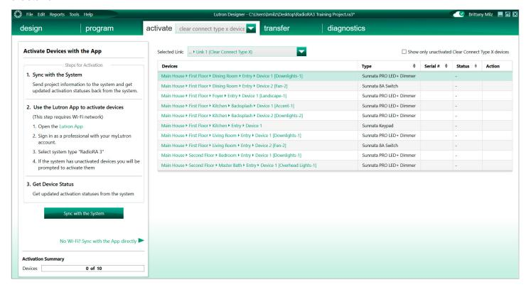
Para los atenuadores, interruptores y teclados Sunnata, sigue las instrucciones para utilizar la aplicación de Lutron y activar estos dispositivos en el sistema
