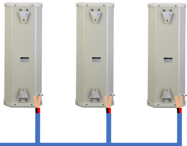
La combinación de potencia total de la línea no debe sobrepasar el 80% de la salida de su amplificador.
