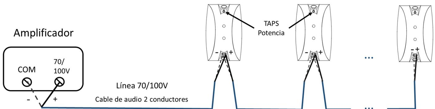
**NOTA: La combinación de potencia total de la línea de altavoces no debe sobrepasar el 80% de la salida de potencia nominal del amplificador.**
