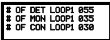
En el ejemplo anterior, la pantalla indica que el lazo SLC tiene 55 detectores direccionables, 35 módulos de monitoreo y 30 módulos instalados. Al presionar la tecla ESC, la pantalla regresará a la Pantalla de programación # 1.
