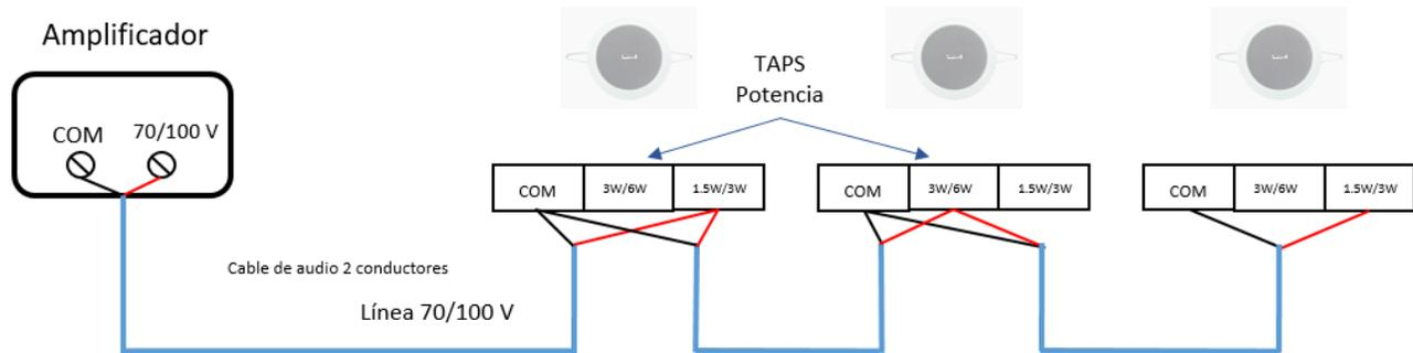
La combinación de potencia total de la línea no debe sobrepasar el 80% de la salida de su amplificador.
