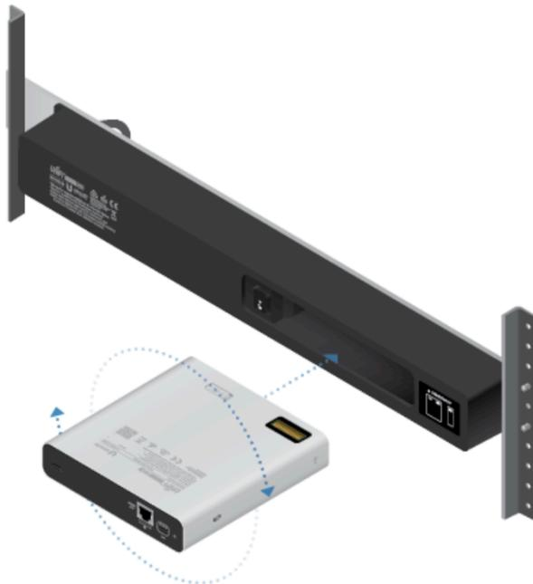
**!** **Advertencia:** Para evitar la creación de un circuito u otro comportamiento desfavorable en la red, solo debería utilizarse una conexión Ethernet. No utilice el puerto Ethernet del Cloud Key Gen2 Plus y el accesorio de montaje en bastidor al mismo tiempo.
