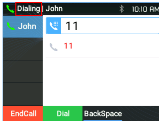
Figura 1 6 : Marcación con el teléfono descolgado
