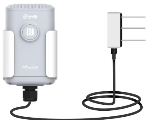
EM500-SMTC está diseñado para medir humedad del suelo, temperatura y conductividad eléctrica en entornos hostiles y transmitiendo datos utilizando la tecnología LoRaWAN®. Con esta tecnología de bajo consumo de energía, EM500-SMTC puede funcionar hasta 10 años con una batería de 19000 mAh. En combinación con la puerta de enlace Milesight LoRaWAN® y la solución Milesight IoT Cloud, los usuarios pueden administrar todos los datos de los sensores de forma remota y visual.
