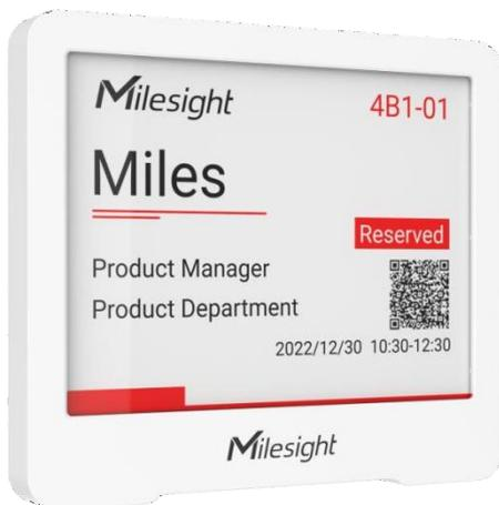
DS3604-915M es una pantalla electroforética reflectante que ofrece legibilidad y flexibilidad. El área activa de 4,2 pulgadas contiene 400 x 300 píxeles y tiene capacidades de visualización completa en negro/blanco/rojo de 1 bit. DS3604 admite la visualización de hasta 150 idiomas y otros módulos como imagen o código QR. Las baterías de larga capacidad y el consumo de energía ultra-bajo brindan una vida útil prolongada de la batería de hasta 5 años.
