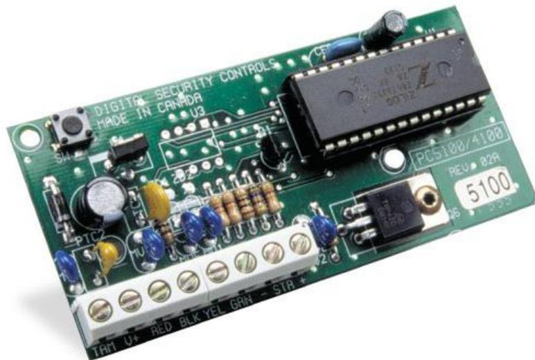
El PC5100 es un módulo de interface para los controles de alarma PC5010 y PC5015. El módulo es usado para conectar dispositivos dirigibles de 2-hilos al Sistema de Seguridad Power832. Consumo de Corriente: 40mA Consumo máximo de corriente de un circuito dirigible: 170mA Hasta 32 dispositivos dirigibles de 2-hilos pueden ser agregados al sistema. Compatibilidad: PC5010 v2.x o superior; PC5015 v2.x o superior.
