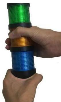
3. Conecte el conector de cinta (Asegúrese de que las ranuras del conector hembra queden hacia el exterior)
