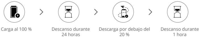
Cargue la batería por completo o al nivel de energía adecuado para el almacenamiento después de completar el mantenimiento de la batería. Póngase en contacto con Asistencia técnica de DJI si persiste un fallo de mantenimiento.
