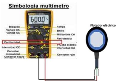
*Imagen A.2 Prueba con multímetro*
