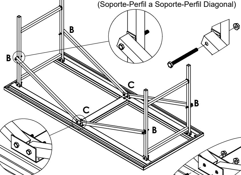
Atornille los tornillos de 2 pulgadas de largo sobre los puntos C de anclaje.
