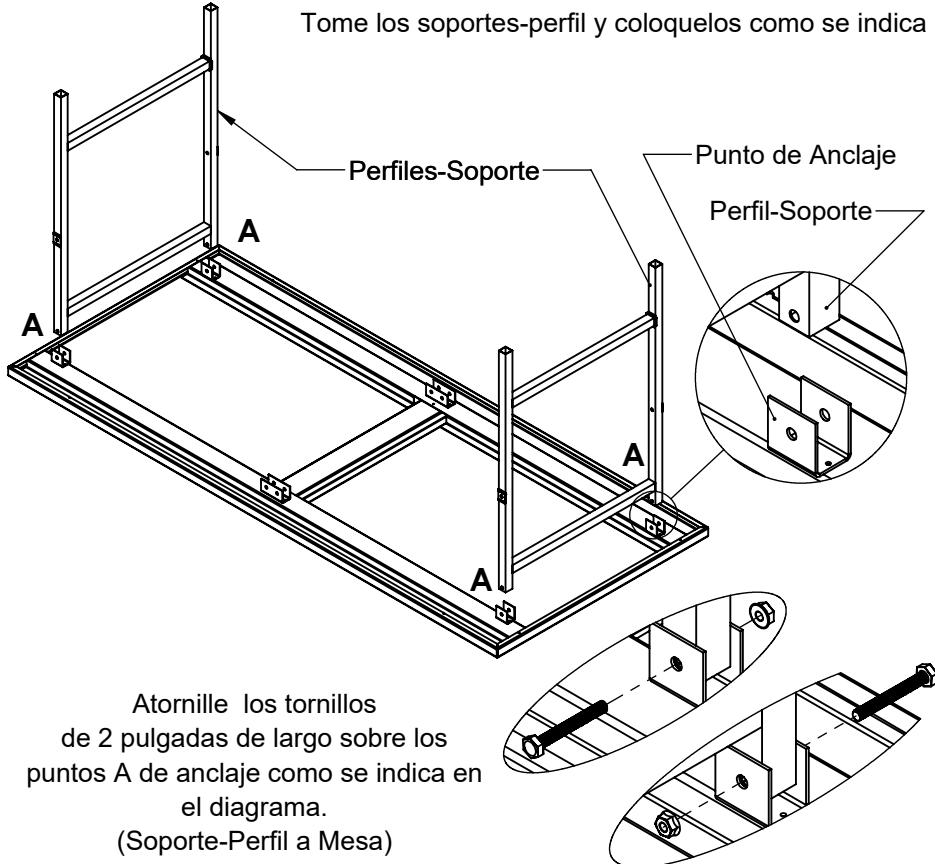
Atornille los tornillos de 2 pulgadas de largo sobre los puntos A de anclaje como se indica en el diagrama.
