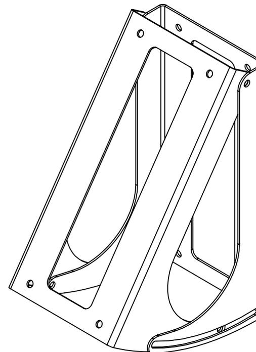
1. Fabricado en lámina de Acero SAE 1008 calibre 18.
