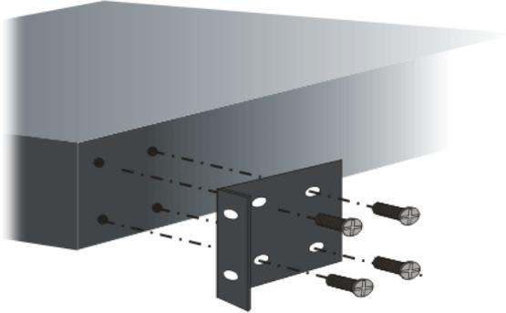
2. Luego, instale el VigorSwitch (con el kit de montaje en bastidor) en el chasis de 19 pulgadas usando otros cuatro tornillos.
