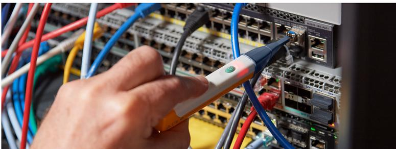
Determina si un transceptor es operativo. El FiberLert puede detectar señales de fibra sin hacer contacto.
